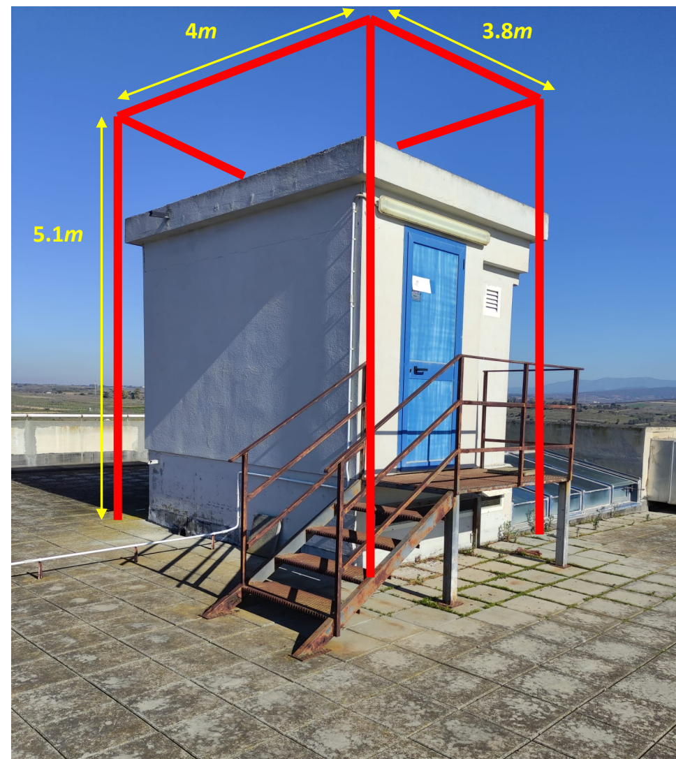
Schema della struttura metallica che sorreggerà il piano orizzontale su cui verrà posizionato il radar
